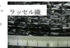
実3 光源に遮光ネット(ラッセル織)をかぶせ、照度の変化を測定し照度の減少率を求める。
