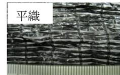
実1 暗室で蛍光灯と照度計を 50lux になる位置に設置し、蛍光灯に遮光ネットをかぶせ 5lux に減少するまでネットを折りたたみ、何枚重ねになっているかを調べる。
