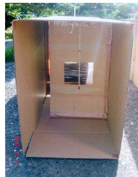
内部に仕切り(横 250 cm×縦 528 cm)を1枚のもの・2枚のもの・しきりが無いもの「3つのダンボールハウスを作り、まん中と出口で温度を測定。
