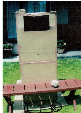
窓から入る風で、中の温度がどのように変化するかを測定。温度計は上・まん中・下にそれぞれ設置。
