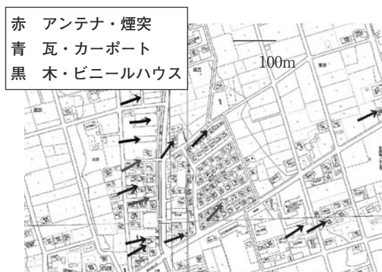
図2 アンテナなどの倒壊方向（磐田市広野地区）
