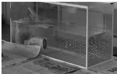
写真3 90cm水槽を利用した水流検出装置
