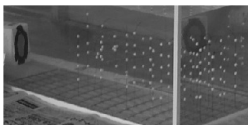
写真4 発砲スチロール利用の玉浮型検出器
