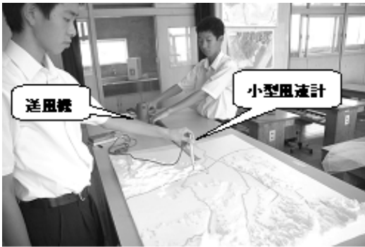
図 11 地形模型実験の様子
