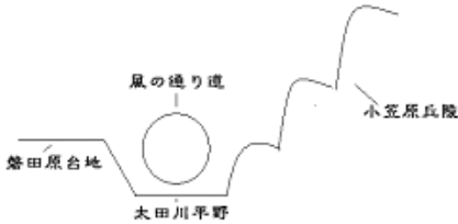
図 14 突風と地形の関係を示す断面図
