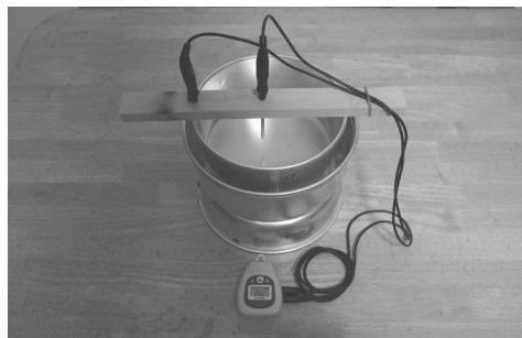
図11 実験機の全体 ストームクッカーに2チャンネル温度ロガーを取り付け、木の棒で温度を測る部分が水の中で一定の位置になるように固定した様子
