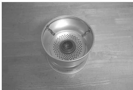
図10 ストームクッカーにアルコールバーナーをセットしたところ
