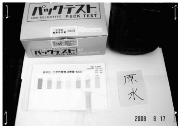
写真：大池の水の COD パックテスト分析(約50mg/l)
