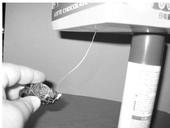
**実験** 米粒大の発ぼうスチロールに糸を結び上から垂らす。鉄電気石をチャッカマンで熱し、石をかるくふり熱を冷ます。発ぼうスチロールに石を寄せる。
