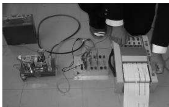
図4 常時微動の観測装置
