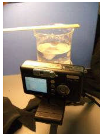
写真2 ミョウバンの結晶の成長を撮影する装置
