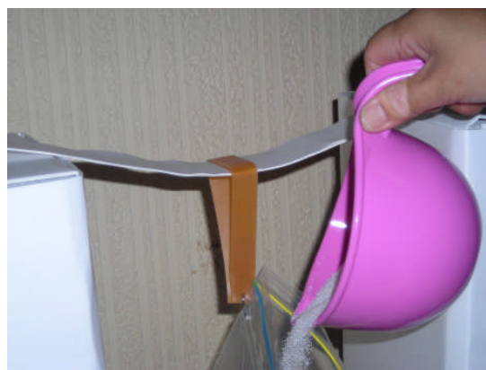
写真3 グラニュー糖で強度測定
