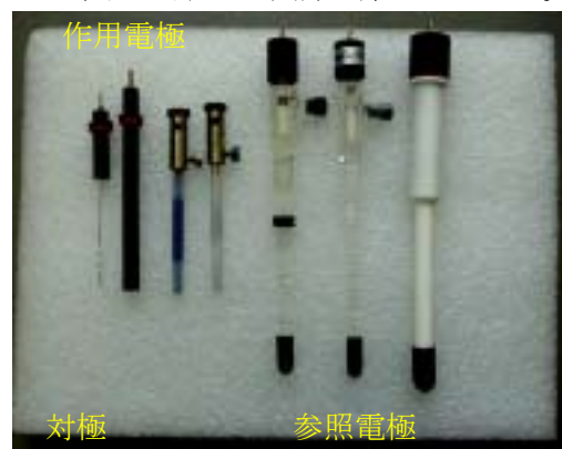
図. 1 使用した7種の電極
