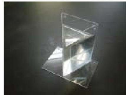
写真4 三角柱型水槽
