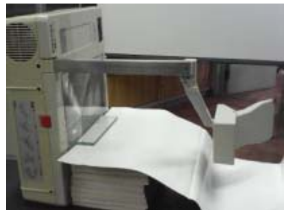
図6 : OHPを横に倒しガラス板に横から光を当てて、スクリーン上に液滴を映し出す様子
