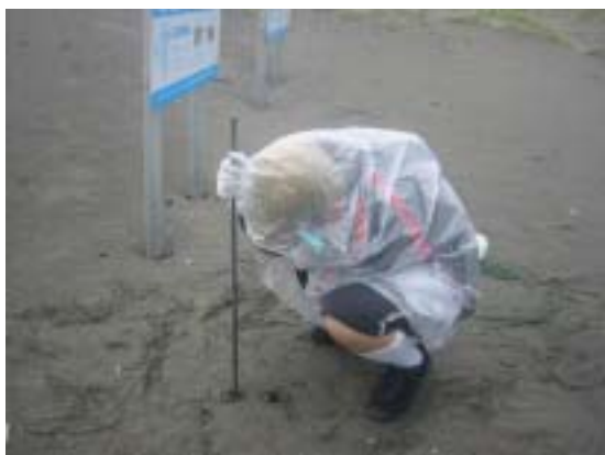
写真8. 砂浜に開けた穴の底の温度を計測する
