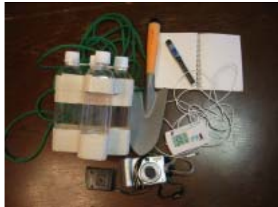
写真3. 研究開始時に準備した計測用具 (左：採水機、右下：温度計)
