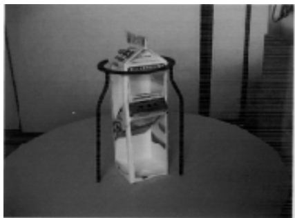
図6 牛乳パックを使った簡易百葉箱
