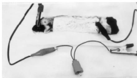
乾電池で代表的なマンガン電池は、亜鉛と炭素棒で電気を起こしている。そこで、炭素棒の代わりに備長炭、亜鉛の代わりにアルミニウム、電解液に飽和食塩水を用いた。炭とアルミニウムを2.2用の電球につなぐと豆電球が光った。電圧は1.06Vあった。
