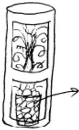
筒の下から線香を入れたところ、筒の中が31 に比べて筒の中が5 の時の方が煙が上っていく時間が長くなった。(コップの中に氷水と食塩を冷やすために入れた。)そして、下の方にも煙が充満しているようにも見えた。
